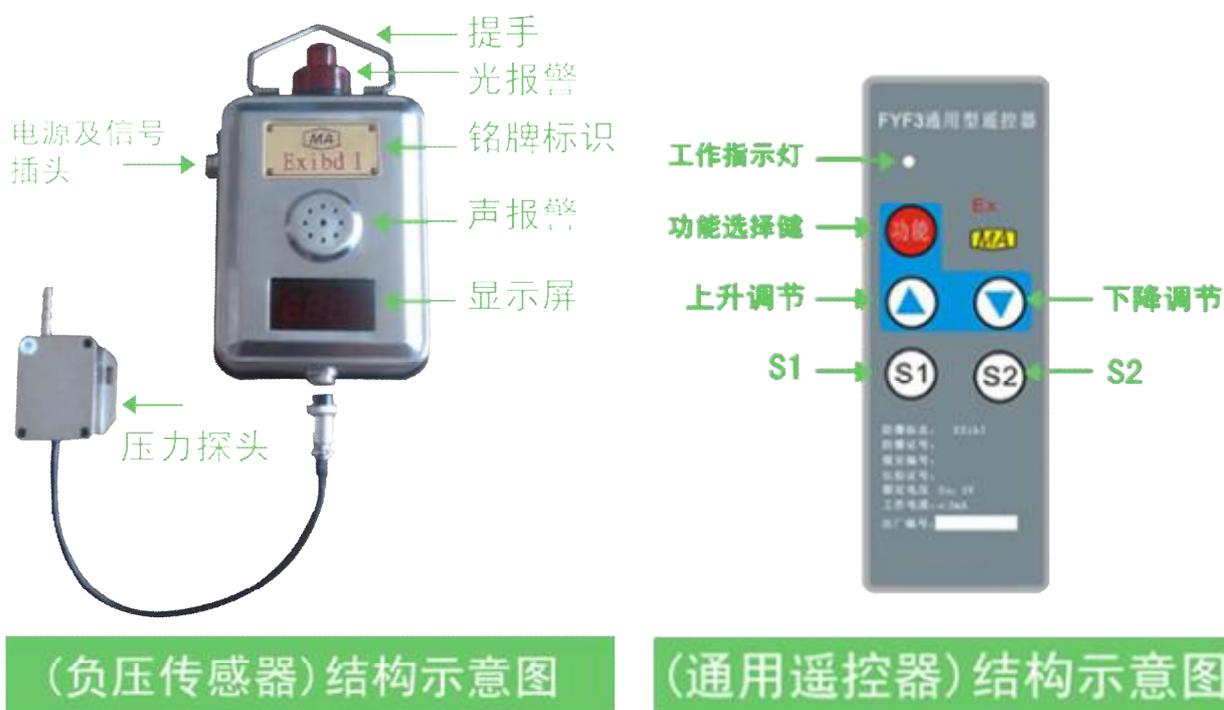
图 2. 传感器结构示意图
