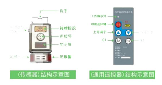
图 2. 传感器结构示意图
